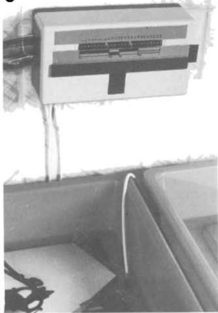
Figura 5. Questa fotografia del temporizzatore di trattamento illustra un esempio di scheda di programmazione.
